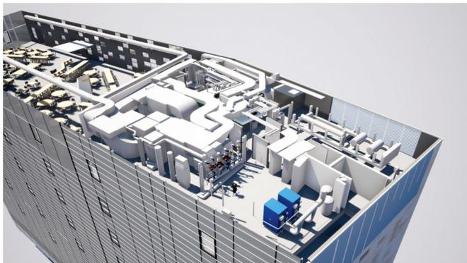
Fig. 7. Maquette numérique de l'école numérique du projet « CARIVRY », montrant l'implantation des réseaux techniques (source : RRC Architectes – image réalisée par BIMtech).
